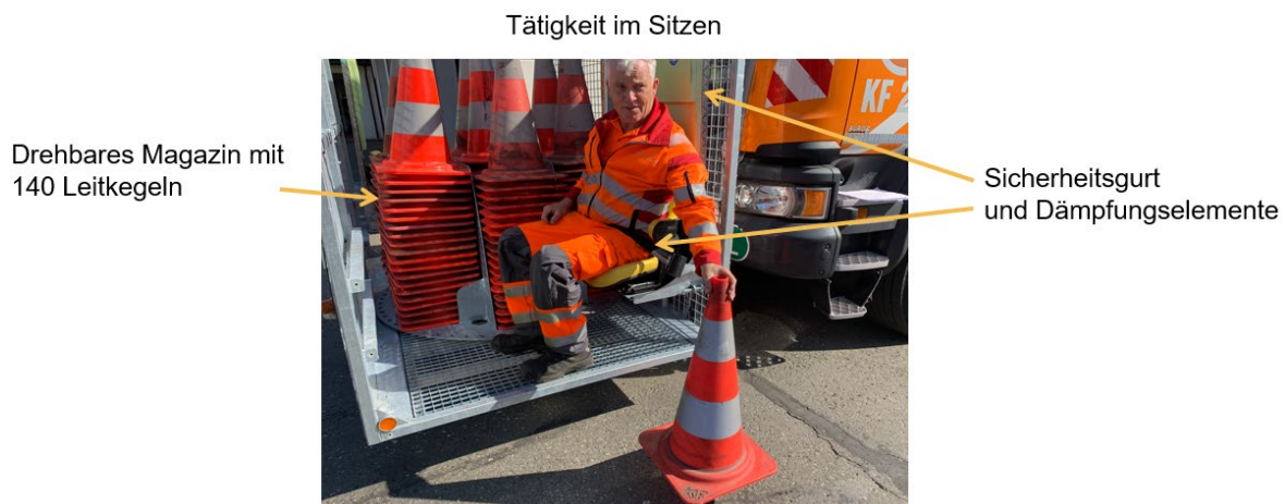
Neuer Arbeitskorb zum Setzen von Leitkegeln
